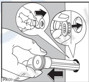
7. Закройте отверстия пластмассовыми пробками, которые вы найдёте на задней панели машины.
