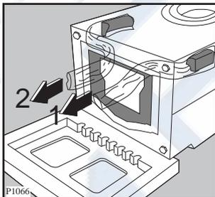
5. Поставьте машину вертикальное положение и удалите остальные два болта с задней панели.
